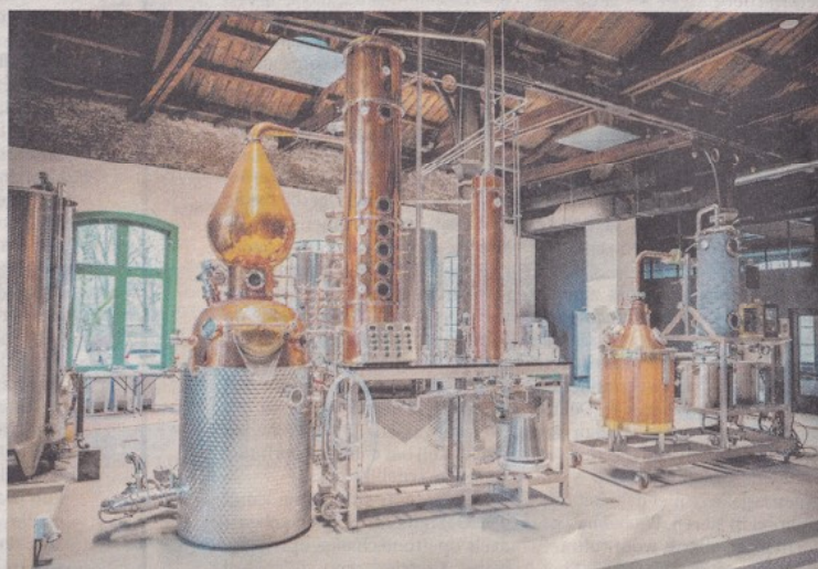
De stoomruimte met daarin de glimmende ketel voor het stoken van jenever.
